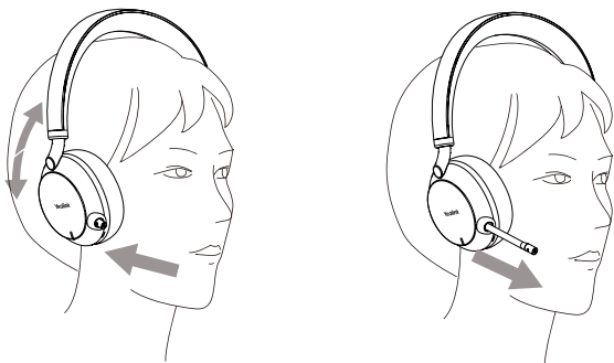
Einziehbarer versteckter Mikrofonarm
