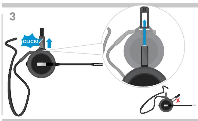
▷ Insérez la broche de recharge dans le support de l'adaptateur de style de port.
