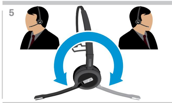
▷ Faites pivoter la flèche du microphone pour changer le côté du port.
