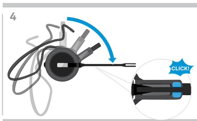
▷ Faites pivoter la flèche pour l'enclencher sur l'adaptateur de style de port.
