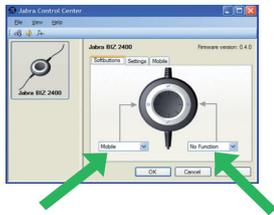
Wählen Sie hierzu aus den Dropdownlisten der verfügbaren Funktionen jeweils eine gewünschte Funktion für jede der zwei Soft-Tasten. Nach Abschluss der Konfiguration können Sie diese Funktionen dann durch Drücken der entsprechenden Taste des USB-Controllers auslösen.
